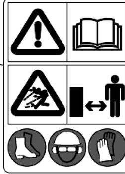
Üfleyicinin çok dikkatli olarak kullanılması gerekir. Bu nedenle makinenin çeşitli yerlerine kullanım ve alınacak tedbirlerle ilgili çıkartmalar konulmuştur. Bu çıkartmalar makinenin bir parçası olup asla sökülmemelidir.
